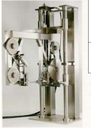
Scie à ruban sous eau à distance (1ère mondiale !)
