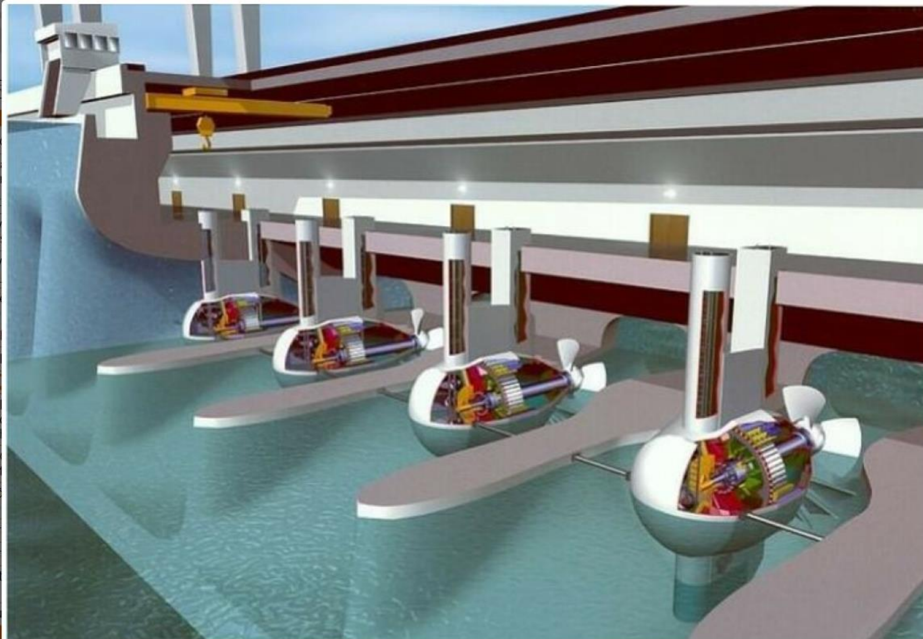
Coupe d'une centrale avec groupe bulbes
